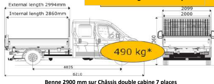
Benne 2900 mm sur Châssis double cabine 7 places
